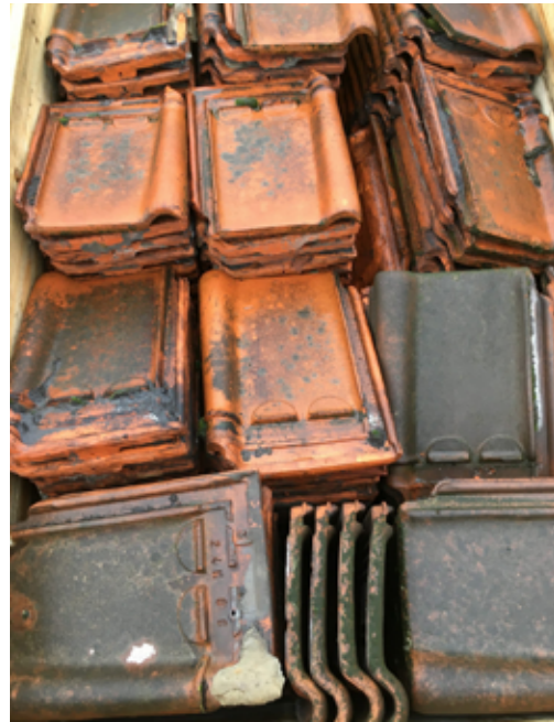
Voorbeeld van het uitzicht van pannen na demontage van een dak
