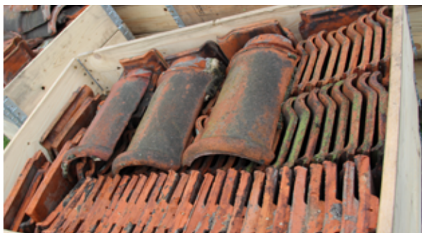
Voorbeeld van het stockeren van dakpannen met het oog op hergebruik (© Buildwise, chantier Tuighuisstraat, Courtrai)
